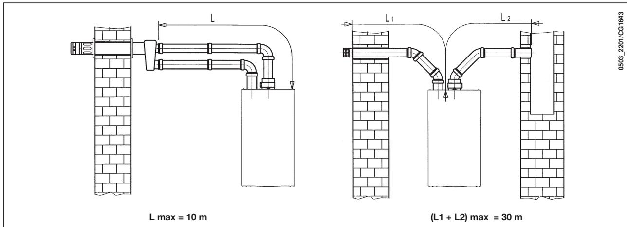
NOTA: Para el tipo C52, los terminales para la entrada de aire comburente y para la evacuación de los productos de la combustión no deben colocarse en paredes opuestas al edificio.
