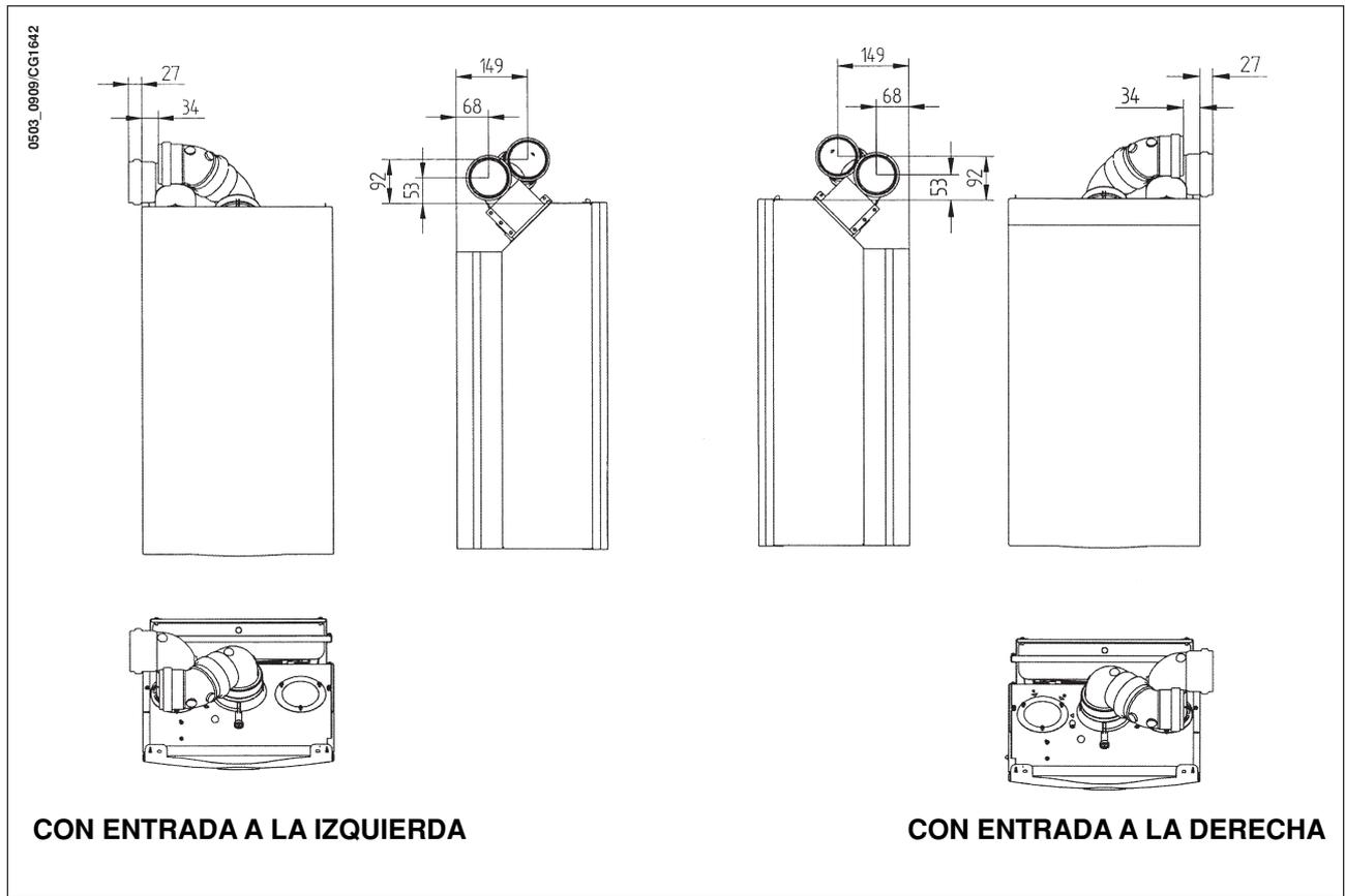
La instalación de un codo a 90° reduce la longitud total del conducto en 0,5 metros.
