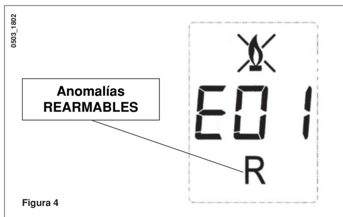
Para rearmar la caldera, ponga el selector de la figura 2 en "R" durante al menos dos segundos. Si este dispositivo actúa repetidamente, llame a un Centro de Asistencia autorizado.
