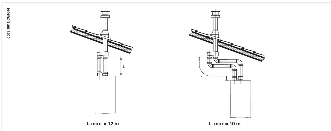
**Importante:** el conducto sencillo para la salida de humos debe aislarse, por ejemplo con manta de lana de vidrio, en los puntos donde toca las paredes del edificio.
